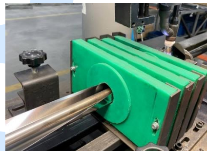
Продольная сварка ленты в трубу под заготовку для сильфона
