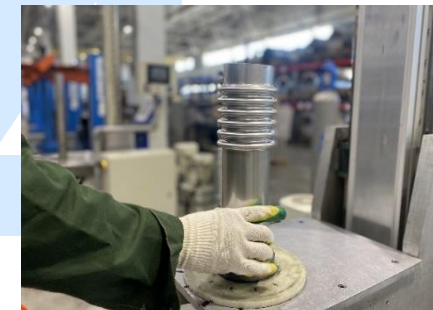
Формирование гофр сильфона
